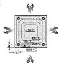
FIGURA 33 - Exemplo de distribuição de temperaturas numa seção de concreto
