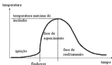
FIGURA 22 - Curva temperatura-tempo de um incêndio real
