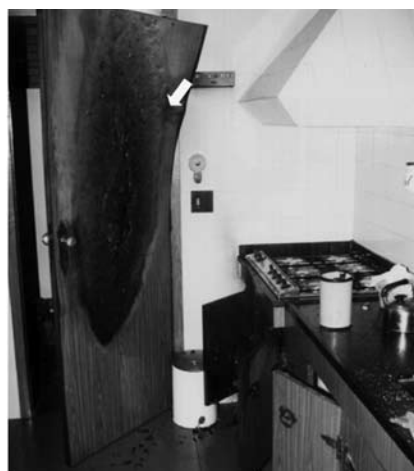
FIGURA 4 - Incêndio em residência causado por vazamento de gás liquefeito de petróleo (GLP) dentro de compartimento sob o fogão
